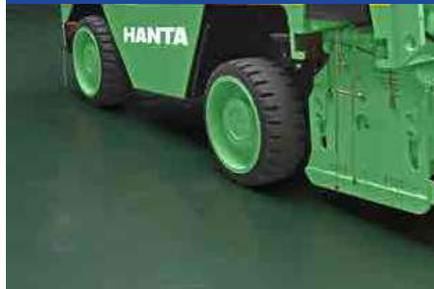
強力な牽引力を発揮させるため、4輪駆動方式(4WD)を採用。1輪がスリップした時でも3輪は駆動するようホイール式の欠点をクリアした油圧回路になっています。
